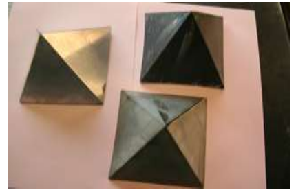
マグネシウム合金の曲げ ピラミッドの曲げ成形
